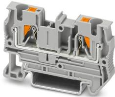
Morsetto passante, tensione nominale: 800 V, corrente nominale: 32 A, numero di connessioni: 2, tipo di connessione: Connessione Push-in, Sezione di dimensionamento: 4 mm<sup>2</sup>, sezione: 0,2 mm<sup>2</sup> - 6 mm<sup>2</sup>, tipo di montaggio: NS 35/7,5, NS 35/15, colore: grigio
