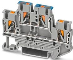
Morsetto passante a due piani, tensione nominale: 500 V, corrente nominale: 22 A, tipo di connessione: Connessione Push-in, 1. e 2. piano, Sezione di dimensionamento: 2,5 mm<sup>2</sup>, sezione: 0,14 mm<sup>2</sup> - 4 mm<sup>2</sup>, tipo di montaggio: NS 35/7,5, NS 35/15, colore: grigio
