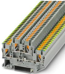
Morsetto a più piani, tensione nominale: 500 V, corrente nominale: 24 A, tipo di connessione: Connessione Push-in, 1. e 2. piano, Sezione di dimensionamento: 2,5 mm<sup>2</sup>, sezione: 0,14 mm<sup>2</sup> - 4 mm<sup>2</sup>, tipo di montaggio: NS 35/7,5, NS 35/15, colore: grigio
