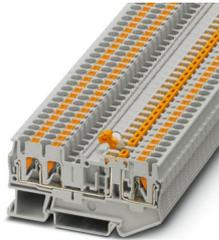
Morsetto con sezionatore a coltello, tensione nominale: 400 V, corrente nominale: 20 A, tipo di connessione: Connessione Push-in, Sezione di dimensionamento: 2,5 mm<sup>2</sup>, sezione: 0,14 mm<sup>2</sup> - 4 mm<sup>2</sup>, montaggio: NS 35/7,5, NS 35/15, colore: grigio
