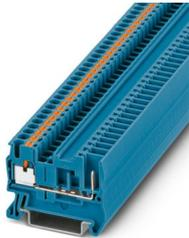
Morsetto passante, tensione nominale: 500 V, corrente nominale: 24 A, numero di connessioni: 2, tipo di connessione: Push-in / attacco connettore, Sezione di dimensionamento: 2,5 mm<sup>2</sup>, sezione: 0,14 mm<sup>2</sup> - 4 mm<sup>2</sup>, tipo di montaggio: NS 35/7,5, NS 35/15, colore: blu
