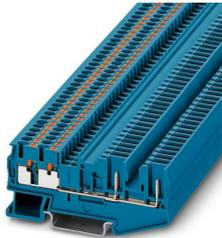
Morsetto passante, tensione nominale: 500 V, corrente nominale: 24 A, numero di connessioni: 4, tipo di connessione: Push-in / attacco connettore, Sezione di dimensionamento: 2,5 mm<sup>2</sup>, 1. piano, sezione: 0,14 mm<sup>2</sup> - 4 mm<sup>2</sup>, tipo di montaggio: NS 35/7,5, NS 35/15, colore: blu
