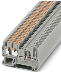
Morsetto passante, tensione nominale: 500 V, corrente nominale: 24 A, numero di connessioni: 3, numero poli: 1, tipo di connessione: Push-in / attacco connettore, Sezione di dimensionamento: 2,5 mm<sup>2</sup>, sezione: 0,14 mm<sup>2</sup> - 4 mm<sup>2</sup>, tipo di montaggio: NS 35/7,5, NS 35/15, colore: grigio
