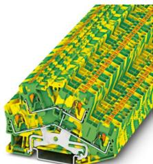
Morsetto a due piani per conduttori di terra, numero di connessioni: 4, tipo di connessione: Connessione Push-in, sezione:  $0,14 \text{ mm}^2 - 4 \text{ mm}^2$ , tipo di montaggio: NS 35/7,5, NS 35/15, colore: giallo-verde
