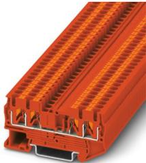
Morsetto passante, tensione nominale: 800 V, corrente nominale: 24 A, numero di connessioni: 4, tipo di connessione: Connessione Push-in, Sezione di dimensionamento: 2,5 mm<sup>2</sup>, sezione: 0,14 mm<sup>2</sup> - 4 mm<sup>2</sup>, tipo di montaggio: NS 35/7,5, NS 35/15, colore: rosso
