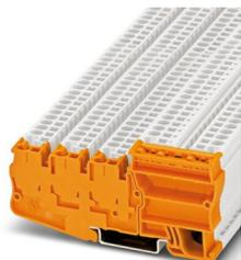
Morsetto di alimentazione, tensione nominale: 250 V, corrente nominale: 30 A, numero di connessioni: 5, tipo di connessione: Connessione a molla, Sezione di dimensionamento: 2,5 mm<sup>2</sup>, sezione: 0,08 mm<sup>2</sup> - 4 mm<sup>2</sup>, tipo di montaggio: NS 35/7,5, NS 35/15, colore: arancione
