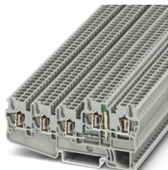
Morsetto iniziatore/attuatore, tensione nominale: 24 V, corrente nominale: 18 A, numero di connessioni: 5, tipo di connessione: Connessione a molla, Sezione di dimensionamento: 2,5 mm<sup>2</sup>, sezione: 0,08 mm<sup>2</sup> - 4 mm<sup>2</sup>, tipo di montaggio: NS 35/7,5, NS 35/15, colore: grigio
