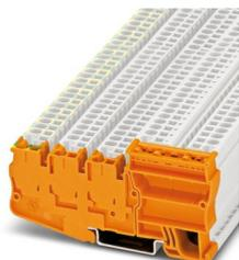
Morsetto per conduttore di terra per installazione, tensione nominale: 250 V, corrente nominale: 30 A, numero di connessioni: 5, tipo di connessione: Connessione a molla, Sezione di dimensionamento: 2,5 mm<sup>2</sup>, sezione: 0,08 mm<sup>2</sup> - 4 mm<sup>2</sup>, tipo di montaggio: NS 35/7,5, NS 35/15, colore: arancione
