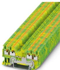
Morsetti comp. per conduttori terra, numero di connessioni: 4, tipo di connessione: Connessione Push-in, 1. piano, sezione:  $0,14 \text{ mm}^2$  -  $1,5 \text{ mm}^2$ , tipo di montaggio: NS 35/7,5, NS 35/15, colore: giallo-verde
