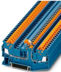
Morsetto con sezionatore a coltello, tensione nominale: 400 V, corrente nominale: 17,5 A, 1. piano, tipo di connessione: Connessione rapida, Sezione di dimensionamento: 1,5 mm<sup>2</sup>, sezione: 0,25 mm<sup>2</sup> - 1,5 mm<sup>2</sup>, montaggio: NS 35/7,5, NS 35/15, colore: blu
