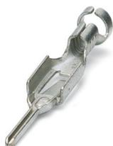
Contatto maschio modulare, viene inserito nella custodia della spina ICC dopo la crimpatura del conduttore, per conduttori da 1,5-2,5 mm<sup>2</sup>
