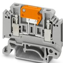
Morsetto con sezionatore a coltello, tensione nominale: 400 V, corrente nominale: 16 A, tipo di connessione: Connessione a vite, Sezione di dimensionamento: 2,5 mm<sup>2</sup>, sezione: 0,2 mm<sup>2</sup> - 4 mm<sup>2</sup>, montaggio: NS 35/7,5, NS 35/15, NS 32, colore: grigio
