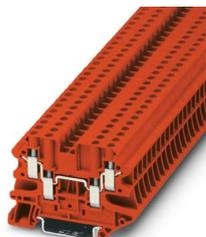
Morsetto universale a quattro conduttori, tensione nominale: 500 V, corrente nominale: 32 A, numero di connessioni: 4, tipo di connessione: Connessione a vite, Sezione di dimensionamento: 4 mm<sup>2</sup>, sezione: 0,14 mm<sup>2</sup> - 6 mm<sup>2</sup>, tipo di montaggio: NS 35/7,5, NS 35/15, colore: rosso
