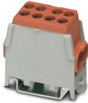
Modulo di derivazione linea principale, tensione nominale: 400 V, corrente nominale: 101 A, numero di connessioni: 4, numero poli: 1, tipo di connessione: Connessione a vite, Sezione di dimensionamento: 25 mm<sup>2</sup>, 1. piano, sezione: 1,5 mm<sup>2</sup> - 25 mm<sup>2</sup>, Connessione a vite, 2. piano, sezione: 1,5 mm<sup>2</sup> - 16 mm<sup>2</sup>, tipo di montaggio: NS 35/7,5, NS 35/15, colore: marrone
