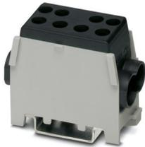
Modulo di derivazione linea principale, tensione nominale: 400 V, corrente nominale: 125 A, numero di connessioni: 4, numero poli: 1, tipo di connessione: Connessione a vite, Sezione di dimensionamento: 35 mm<sup>2</sup>, 1. piano, sezione: 10 mm<sup>2</sup> - 35 mm<sup>2</sup>, Connessione a vite, 2. piano, sezione: 1,5 mm<sup>2</sup> - 25 mm<sup>2</sup>, tipo di montaggio: NS 35/7,5, NS 35/15, colore: nero
