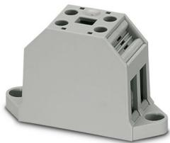
Morsetto apparecch., tensione nominale: 1000 V, corrente nominale: 57 A, numero di connessioni: 4, numero poli: 2, tipo di connessione: Connessione a vite, Sezione di dimensionamento: 10 mm<sup>2</sup>, sezione: 0,5 mm<sup>2</sup> - 16 mm<sup>2</sup>, tipo di montaggio: avvitamento diretto, colore: grigio
