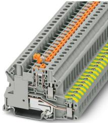
Morsetti comp. per conduttori terra, tensione nominale: 500 V, corrente nominale: 20 A, tipo di connessione: Connessione a vite, Sezione di dimensionamento: 2,5 mm<sup>2</sup>, sezione: 0,14 mm<sup>2</sup> - 6 mm<sup>2</sup>, montaggio: NS 35/7,5, NS 35/15, colore: grigio
