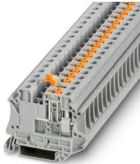
Morsetto con sezionatore a coltello, tensione nominale: 500 V, Corrente continua termica  $I_{th}$ : 20 A, tipo di connessione: Connessione a vite, Sezione di dimensionamento: 6 mm<sup>2</sup>, sezione: 0,2 mm<sup>2</sup> - 10 mm<sup>2</sup>, montaggio: NS 35/7,5, NS 35/15, colore: grigio
