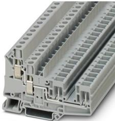
Morsetto passante, tensione nominale: 1000 V, corrente nominale: 41 A, numero di connessioni: 4, tipo di connessione: Connessione a vite/a innesto, Sezione di dimensionamento: 6 mm<sup>2</sup>, sezione: 0,2 mm<sup>2</sup> - 10 mm<sup>2</sup>, tipo di montaggio: NS 35/7,5, NS 35/15, colore: grigio
