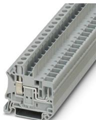
Morsetto passante, tensione nominale: 1000 V, corrente nominale: 41 A, numero di connessioni: 2, tipo di connessione: Connessione a vite/a innesto, Sezione di dimensionamento: 6 mm<sup>2</sup>, sezione: 0,2 mm<sup>2</sup> - 10 mm<sup>2</sup>, tipo di montaggio: NS 35/7,5, NS 35/15, colore: grigio
