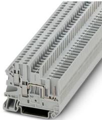
Morsetto passante, tensione nominale: 500 V, corrente nominale: 24 A, numero di connessioni: 3, numero poli: 1, tipo di connessione: Connessione a vite/a innesto, Sezione di dimensionamento: 2,5 mm<sup>2</sup>, sezione: 0,14 mm<sup>2</sup> - 4 mm<sup>2</sup>, tipo di montaggio: NS 35/7,5, NS 35/15, colore: grigio
