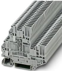
Morsetto passante a due piani, Corrente e tensione sono determinate dalla spina impiegata., tensione nominale: 500 V, corrente nominale: 24 A, tipo di connessione: Connessione a vite/a innesto, Sezione di dimensionamento: 2,5 mm<sup>2</sup>, sezione: 0,14 mm<sup>2</sup> - 4 mm<sup>2</sup>, tipo di montaggio: NS 35/7,5, NS 35/15, colore: grigio
