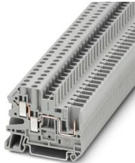
Morsetto passante, tensione nominale: 500 V, corrente nominale: 32 A, numero di connessioni: 3, numero poli: 1, tipo di connessione: Connessione a vite/a innesto, Sezione di dimensionamento: 4 mm<sup>2</sup>, sezione: 0,14 mm<sup>2</sup> - 6 mm<sup>2</sup>, tipo di montaggio: NS 35/7,5, NS 35/15, colore: grigio
