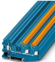
Morsetto passante, tensione nominale: 800 V, corrente nominale: 24 A, tipo di connessione: Connessione rapida, Sezione di dimensionamento: 2,5 mm<sup>2</sup>, sezione: 0,5 mm<sup>2</sup> - 2,5 mm<sup>2</sup>, tipo di connessione: Connessione a vite, Sezione di dimensionamento: 2,5 mm<sup>2</sup>, sezione: 0,14 mm<sup>2</sup> - 6 mm<sup>2</sup>, montaggio: NS 35/7,5, NS 35/15, colore: blu
