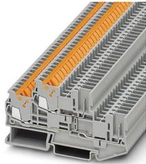
Morsetto passante a due piani, Corrente e tensione sono determinate dalla spina impiegata., tensione nominale: 500 V, corrente nominale: 17,5 A, tipo di connessione: Connessione rapida/a innesto, Sezione di dimensionamento: 1,5 mm<sup>2</sup>, sezione: 0,25 mm<sup>2</sup> - 1,5 mm<sup>2</sup>, tipo di montaggio: NS 35/7,5, NS 35/15, colore: grigio
