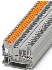
Morsetto passante, tensione nominale: 500 V, corrente nominale: 17,5 A, numero di connessioni: 2, tipo di connessione: Connessione rapida/a innesto, Sezione di dimensionamento: 1,5 mm<sup>2</sup>, 1. Piano attacco sinistra, sezione: 0,25 mm<sup>2</sup> - 1,5 mm<sup>2</sup>, 1. piano, collegamento a destra, tipo di montaggio: NS 35/7,5, NS 35/15, colore: grigio
