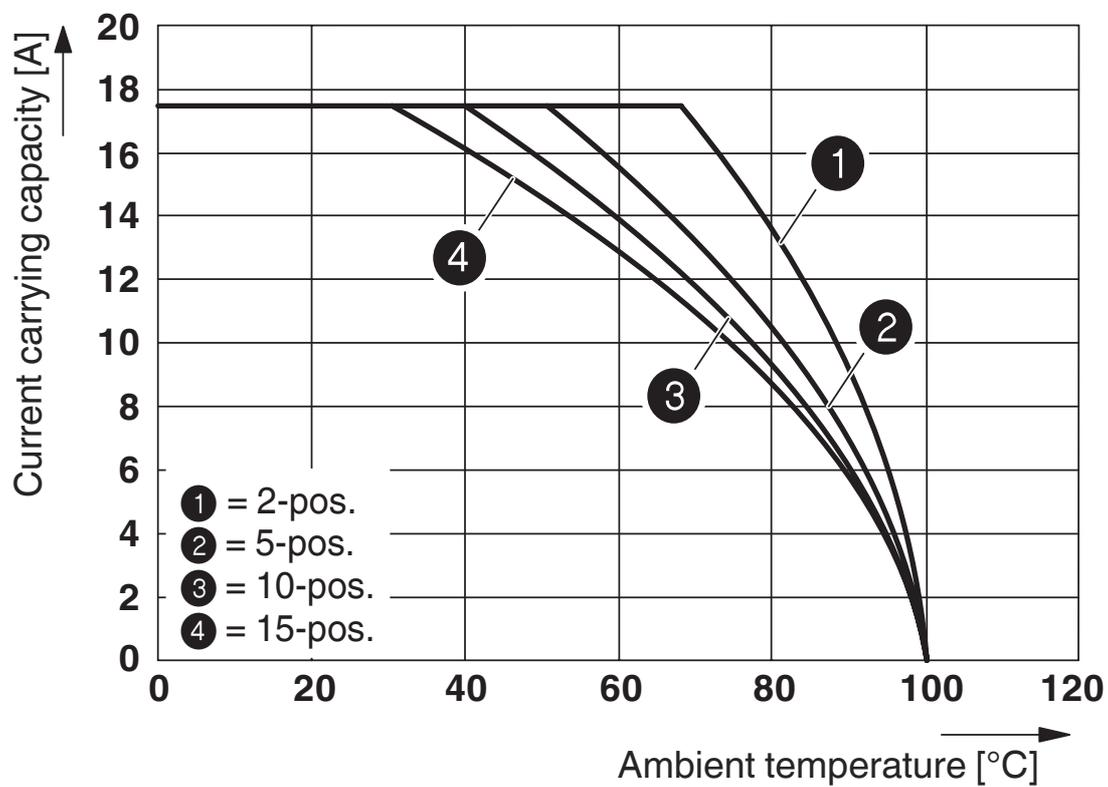
La figura mostra la curva di declassamento del morsetto QTC 1,5/ 1P... in combinazione con il connettore QP 1,5
