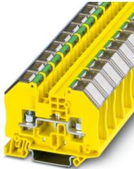
Morsetti comp. per conduttori terra, Attenzione: per i capocorda non isolati impiegare l'estensione di linee BE-RT... (vedere accessori)!, tensione nominale: 1000 V, corrente nominale: 41 A, numero di connessioni: 2, tipo di connessione: Bullone, 1. piano, Sezione di dimensionamento: 6 mm<sup>2</sup>, tipo di montaggio: NS 35/7,5, NS 35/15, colore: giallo-verde
