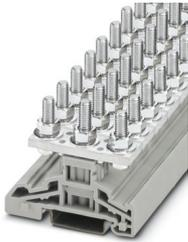
Morsetti di potenza, tensione nominale: 1000 V, corrente nominale: 125 A, numero di connessioni: 2, tipo di connessione: Bullone, Sezione di dimensionamento: 35 mm<sup>2</sup>, tipo di montaggio: NS 35/7,5, NS 35/15, colore: grigio
