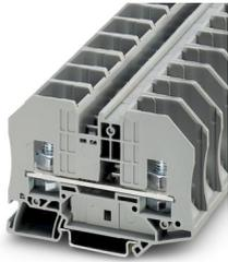
Morsetto di collegamento a bullone, tensione nominale: 1000 V, corrente nominale: 125 A, numero di connessioni: 2, numero poli: 1, tipo di connessione: Bullone, Sezione di dimensionamento: 35 mm<sup>2</sup>, tipo di montaggio: NS 35/7,5, NS 35/15, colore: grigio
