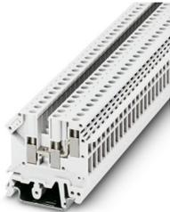
Morsetto a 1 piano con attacco doppio su un lato, sezione: 0,2-4 mm<sup>2</sup>, AWG: 24- 12, spessore: 6,2 mm, colore: bianco
