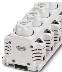
Morsetto portafusibili, tipo di fusibile: Cartuccia a vite, tipo fusibile: D II / E 27, tensione nominale: 500 V, corrente nominale: 25 A, tipo di connessione: Connessione a vite, Sezione di dimensionamento: 35 mm<sup>2</sup>, sezione: 1,5 mm<sup>2</sup>- 35 mm<sup>2</sup>, tipo di montaggio: NS 35/7,5, NS 35/15, colore: grigio chiaro
