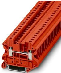
Morsetto passante, tensione nominale: 800 V, corrente nominale: 32 A, numero di connessioni: 2, numero poli: 1, tipo di connessione: Connessione a vite, Sezione di dimensionamento: 4 mm<sup>2</sup>, sezione: 0,14 mm<sup>2</sup> - 6 mm<sup>2</sup>, tipo di montaggio: NS 35/7,5, NS 35/15, colore: rosso
