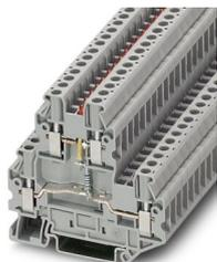
Componente morsetto componibile, La tensione è determinata dal tipo di LED scelto., tipo di connessione: Connessione a vite, Sezione di dimensionamento: 2,5 mm<sup>2</sup>, sezione: 0,14 mm<sup>2</sup> - 4 mm<sup>2</sup>, tipo di montaggio: NS 35/7,5, NS 35/15, colore: grigio
