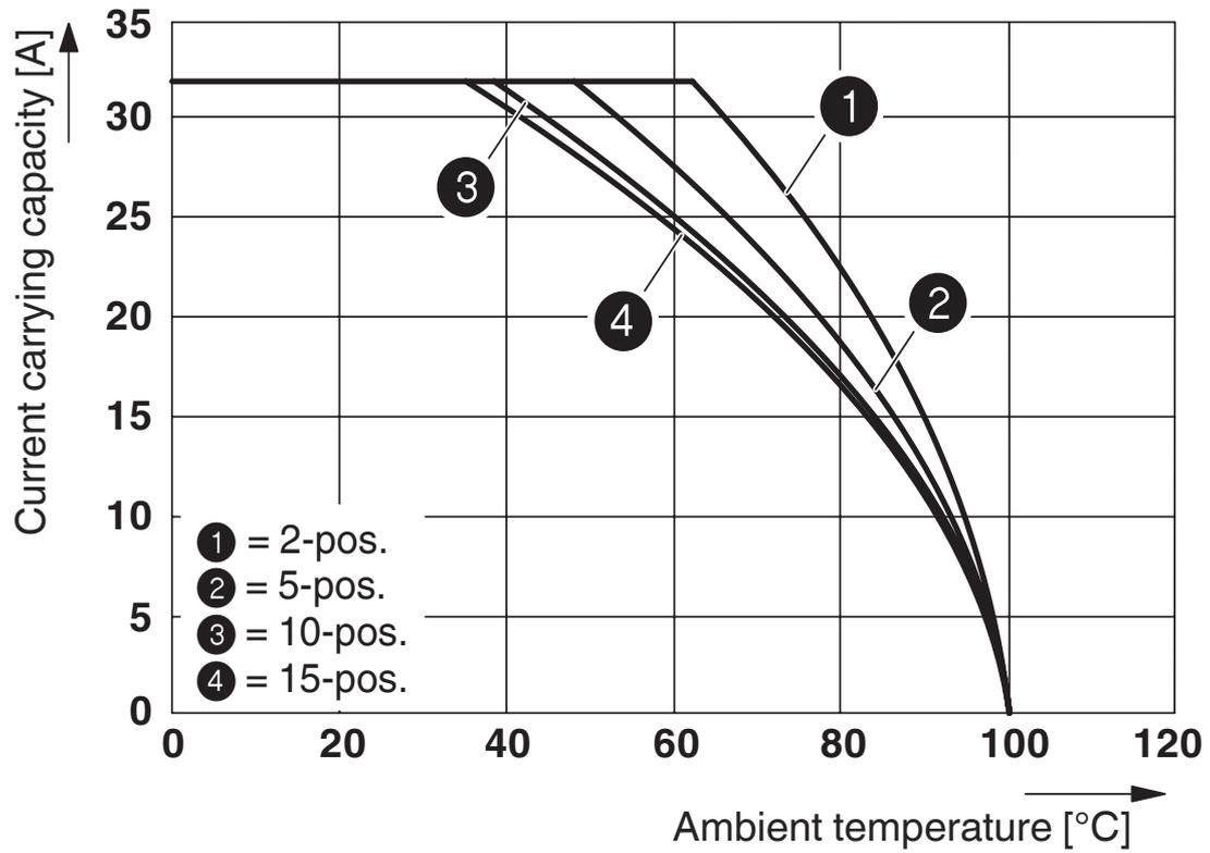
La figura mostra la curva di declassamento del morsetto UT 4/1P... in combinazione con il connettore UPVB 4
