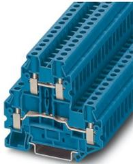
Morsetto a due piani con connessione a vite, sezione: 0,14 mm<sup>2</sup> - 6 mm<sup>2</sup>, AWG: 26- 10, spessore: 6,2 mm, colore: blu
