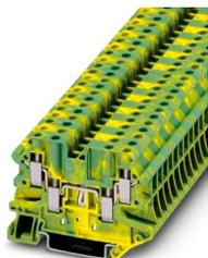
Morsetti comp. per conduttori terra, numero di connessioni: 4, tipo di connessione: Connessione a vite, 1. piano, sezione: 0,14 mm<sup>2</sup> - 6 mm<sup>2</sup>, tipo di montaggio: NS 35/7,5, NS 35/15, colore: giallo-verde
