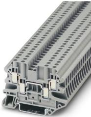
Morsetto passante, tensione nominale: 500 V, corrente nominale: 24 A, numero di connessioni: 4, tipo di connessione: Connessione a vite, Sezione di dimensionamento: 2,5 mm<sup>2</sup>, sezione: 0,14 mm<sup>2</sup> - 4 mm<sup>2</sup>, tipo di montaggio: NS 35/7,5, NS 35/15, colore: grigio
