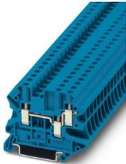
Morsetto passante, tensione nominale: 500 V, corrente nominale: 32 A, numero di connessioni: 3, tipo di connessione: Connessione a vite, Sezione di dimensionamento: 4 mm<sup>2</sup>, sezione: 0,14 mm<sup>2</sup> - 6 mm<sup>2</sup>, tipo di montaggio: NS 35/7,5, NS 35/15, colore: blu
