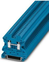
Morsetto passante, tensione nominale: 1000 V, corrente nominale: 24 A, numero di connessioni: 2, tipo di connessione: Connessione a vite, Sezione di dimensionamento: 2,5 mm<sup>2</sup>, sezione: 0,14 mm<sup>2</sup> - 4 mm<sup>2</sup>, tipo di montaggio: NS 35/7,5, NS 35/15, colore: blu
