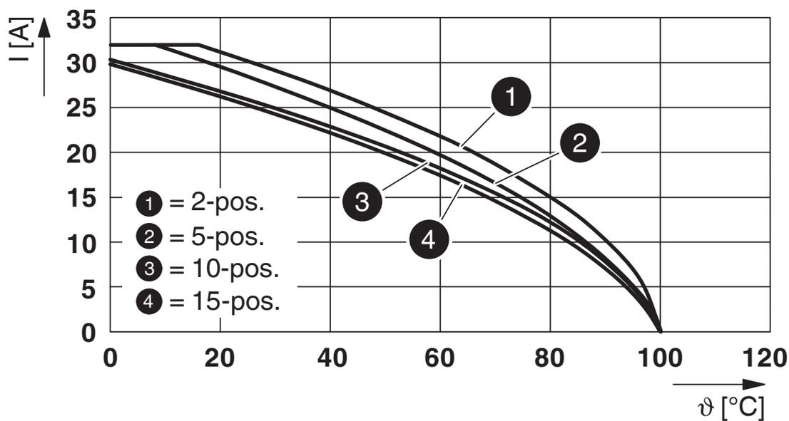
Curva derating per morsetti a molla ST 4/1P.. e ST 4/2p.. con tutte le versioni di connettore SP4/... . Le curve derating si determina moltiplicando i valori delle curve base per il fattore 0,8.
