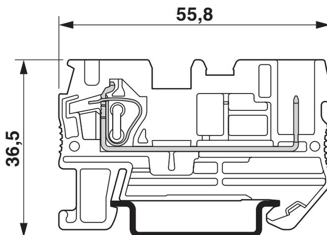
La figura mostra il morsetto con la versione connettore SP4/...
