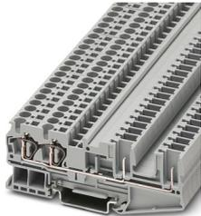
Morsetto passante, tensione nominale: 800 V, corrente nominale: 32 A, numero di connessioni: 4, tipo di connessione: Connessione a molla/a innesto, Sezione di dimensionamento: 4 mm<sup>2</sup>, 1. piano, collegamento a destra, sezione: 0,08 mm<sup>2</sup> - 6 mm<sup>2</sup>, tipo di montaggio: NS 35/7,5, NS 35/15, colore: grigio
