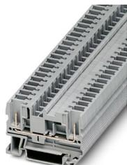
Morsetto passante, tensione nominale: 800 V, corrente nominale: 32 A, numero di connessioni: 2, tipo di connessione: Attacco connettore, Sezione di dimensionamento: 4 mm<sup>2</sup>, 1. Piano attacco sinistra, sezione: 0,08 mm<sup>2</sup> - 6 mm<sup>2</sup>, tipo di montaggio: NS 35/7,5, NS 35/15, colore: grigio
