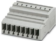
Giunto COMBI, tensione nominale: 800 V, corrente nominale: 32 A, numero di connessioni: 2, numero poli: 8, tipo di connessione: Connessione a molla, Sezione di dimensionamento: 4 mm<sup>2</sup>, sezione: 0,08 mm<sup>2</sup> - 6 mm<sup>2</sup>, colore: grigio
