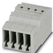
Giunto COMBI, tensione nominale: 500 V, corrente nominale: 24 A, numero di connessioni: 1, numero poli: 4, tipo di connessione: Connessione a molla, Sezione di dimensionamento: 2,5 mm<sup>2</sup>, sezione: 0,08 mm<sup>2</sup> - 4 mm<sup>2</sup>, colore: grigio
