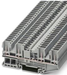
Morsetto passante, tensione nominale: 500 V, corrente nominale: 24 A, numero di connessioni: 4, tipo di connessione: Attacco connettore, Sezione di dimensionamento: 2,5 mm<sup>2</sup>, 1. piano, sezione: 0,08 mm<sup>2</sup> - 4 mm<sup>2</sup>, tipo di montaggio: NS 35/7,5, NS 35/15, colore: grigio
