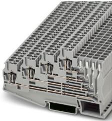
Morsetto a più piani, tensione nominale: 250 V, corrente nominale: 10 A, numero di connessioni: 5, tipo di connessione: Connessione a molla/a innesto, Sezione di dimensionamento: 1,5 mm<sup>2</sup>, sezione: 0,08 mm<sup>2</sup> - 4 mm<sup>2</sup>, tipo di montaggio: NS 35/7,5, NS 35/15, colore: grigio
